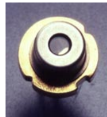
高速・高出力を実現した赤外スーパーluminescentダイオード(SLD)
