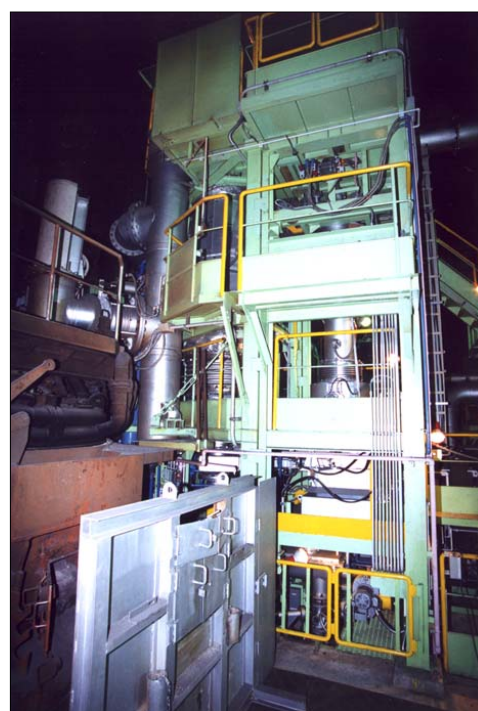
写真-1 小型パイロットプラント試験装置 (左下に電気炉がある)
