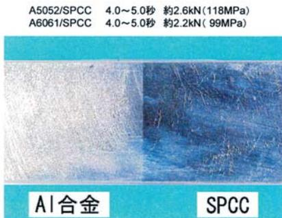
図-6 超音波突き合わせ接合例と接合強度
