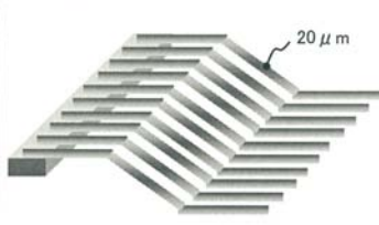
電析ナノ結晶合金の特性を利用した精密プレス加工による3次元マイクロ成形の実現
