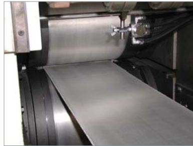
図-3 TRC法による6000系アルミ合金の試験状況
