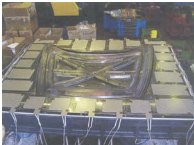
図-1 ボンネットインナー、ブランク用フィルムヒーターの組み込み状況
