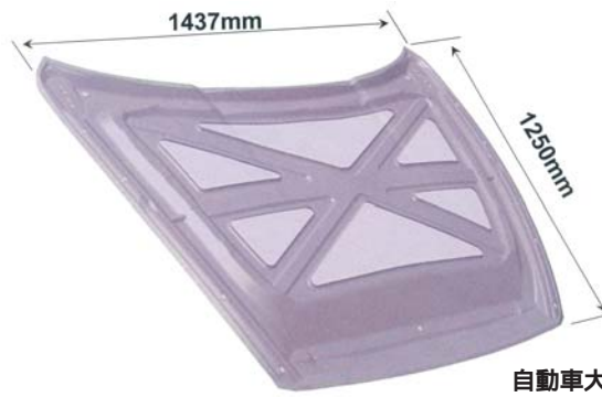
図-2 本プロジェクトで成功したマグネシウムプレス成形品
