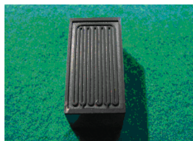
図-1 SEMOS型ヒートパイプ用金型
