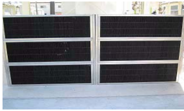
図2 活性炭繊維シートを用いた平行板型拡散スクラバーを2台並べた概観
