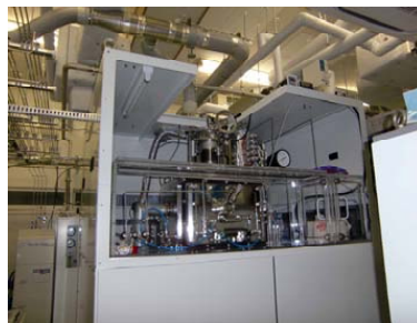
図 2 超高速バルブスイッチング高温 MOVPE 装置への高温対応チャンバー及び排気システムの外観
