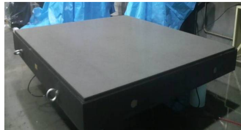
本事業で作製した G8 サイズ多孔質セラミック定盤の外観写真 (約 3.4 畳の大きさ)
