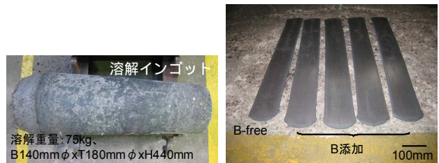
図8 金属間化合物強化型新オーステナイト系鋼の溶解インゴットと熱延板
