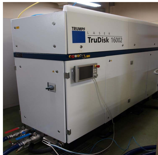
図5 16kW レーザ溶接装置（発振器）
