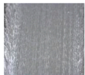
図11 60°超硬工具 (倍率25倍) 粗さ計データ3箇所平均: Ra0.79 μm
