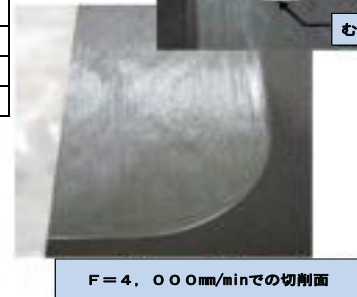
図3 SLダイヤモンド工具（粒度0.75mm）での切削実験結果
