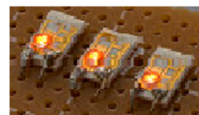
図1 Eu添加GaInを用いた赤色LED
