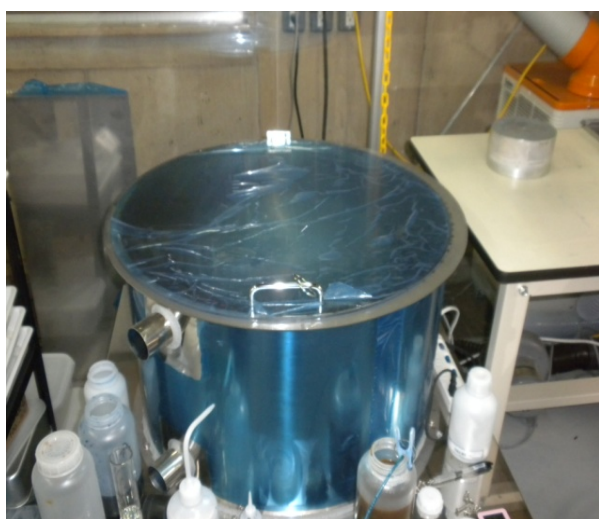
図2 PB塗布スプレー装置
