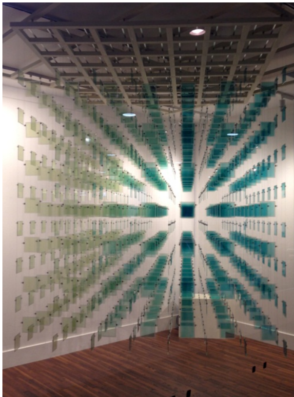
図4 約1000個のECDを強調動作させた3次元ディスプレイ
