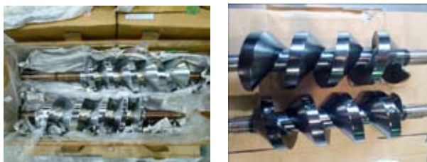
図4 特殊ニッケル後とダイヤモンド膜成膜後の部品
