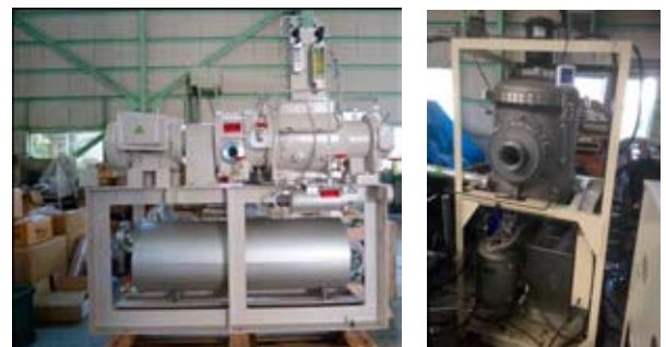
図5 高耐食性真空ポンプ及び溶剤リサイクル装置
