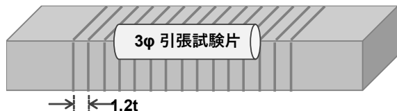
図1 316L-HNi 拡散接合材の模式図
