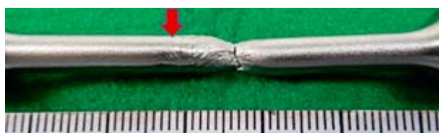
図 5 STH2 溶接継ぎ手の室温・大気中引張試験後の外観例、赤い矢印先：溶接部
