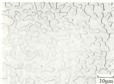
図2 P/M HIP法により得られた均一で微細な組織(MA55C HIPロール組織写真)
