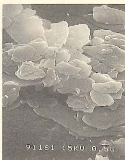
UV吸収合成マイカの走査型電子顕微鏡写真（倍率：1万倍）
